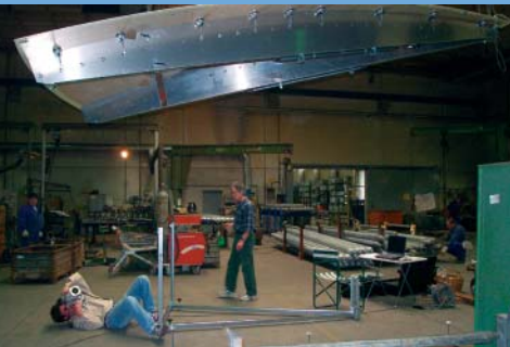
Photogrammetrische Messung eines freischwebenden Bauteiles Photogrammetric Measurement of a free floating Object
