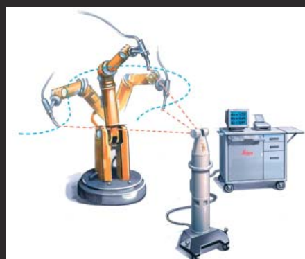
Schema einer Roboter-messung Sketch of a Robot Measurement
