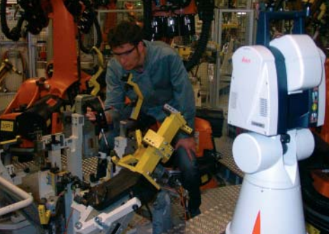
Vorrichtungsmessung mit Lasertracker und T-Probe Equipment Measurement with Lasertracker and T-Probe
